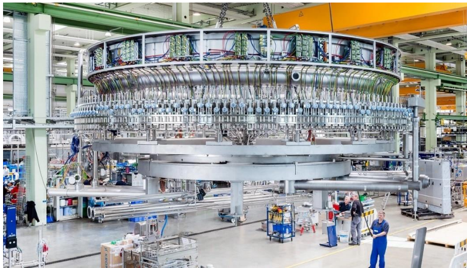
Abfüllanlage am 63 Tonnen Kran
