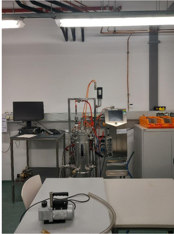
Fermenter, mit dem bis zu 15kg Protein hergestellt werden kann
